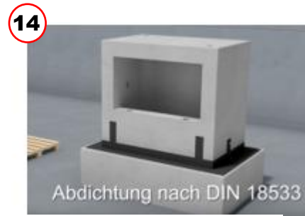
Abdichtung an Untergrund nach DIN 18533
