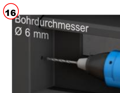
Mit einem Ø 6 mm Bohrer durch die 4 vorgesehenen Bohrungen in den Beton bohren.
