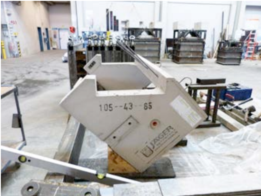
Bildunterschrift: Bild_SL_Lichtschacht_schräg: Sonderanfertigung Lichtschacht mit schräg eingebautem Boden
